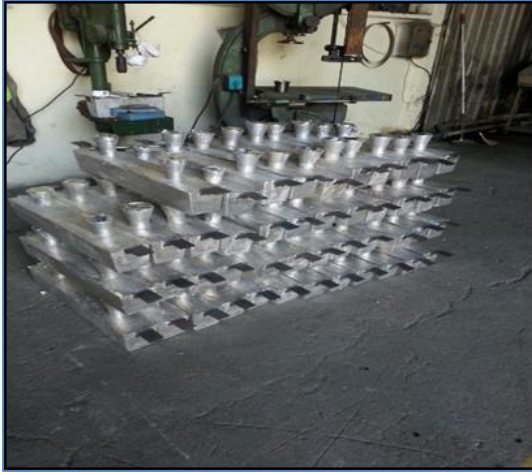
Resim 3. Alüminyum Anot İmalatı -1
